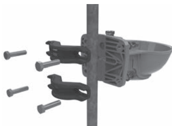
Montage sur conduite
